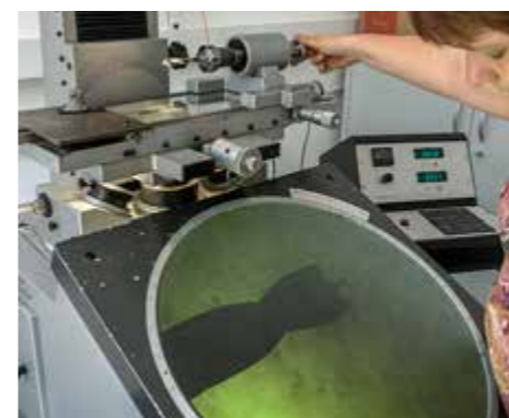
Bei der VPA -Maßprüfung mit dem Profilprojektor gab es keine Beanstandungen.
