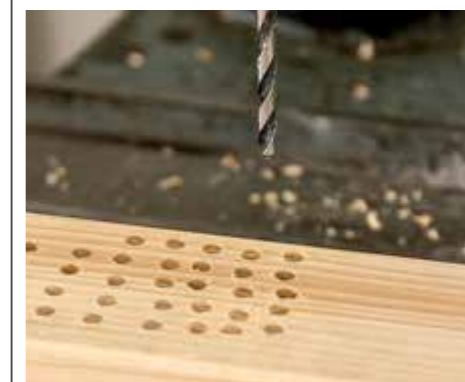
- VERSCHLEISS: Bei einigen Bohrern (hier JN Tools ) ist Verschleiß spürbar.
