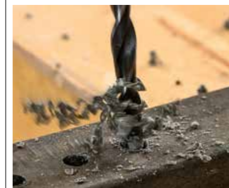
- ANHÄNGLICH: Die Bohrcraft -Wendel setzt sich beim WPC-Bohren schnell zu.
