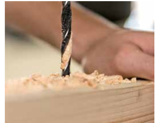
- REIBUNG: Bleibt das Bohrmehl in der Wendelung haften, erhöht sich die Reibung – der Vortrieb fällt schwer, der Bohrer läuft heiß.
