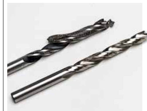
UNTERSCHIED: Mit beiden Bohrern wurde WPC gebohrt, die Hawera -Wendel setzt sich zu.
