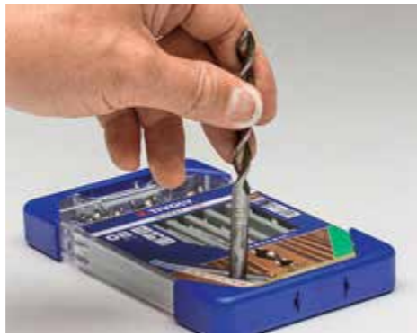
+ MASS: Bei diesem Tivoly -Set kann man die Dimension am Schaft messen.
