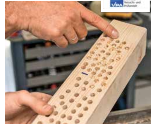
+ SAUBER: Bei 1000 Umdrehungen pro Minute erzielten nur wenige Bohrer eine saubere Bohrlochkante – wie im unteren Bereich der KWB Akku Plus -Bohrer.
