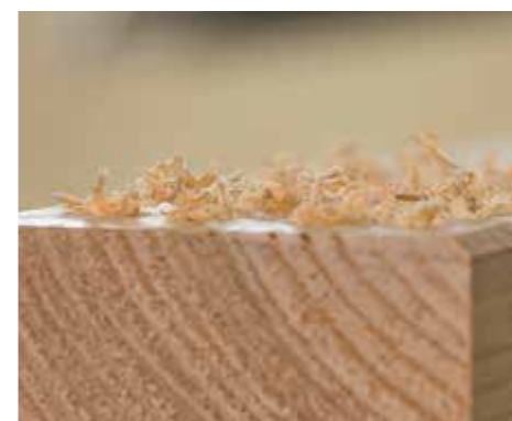
- UNSAUBER: Viele Bohrer schneiden die Holzfasern nicht sauber ab.
